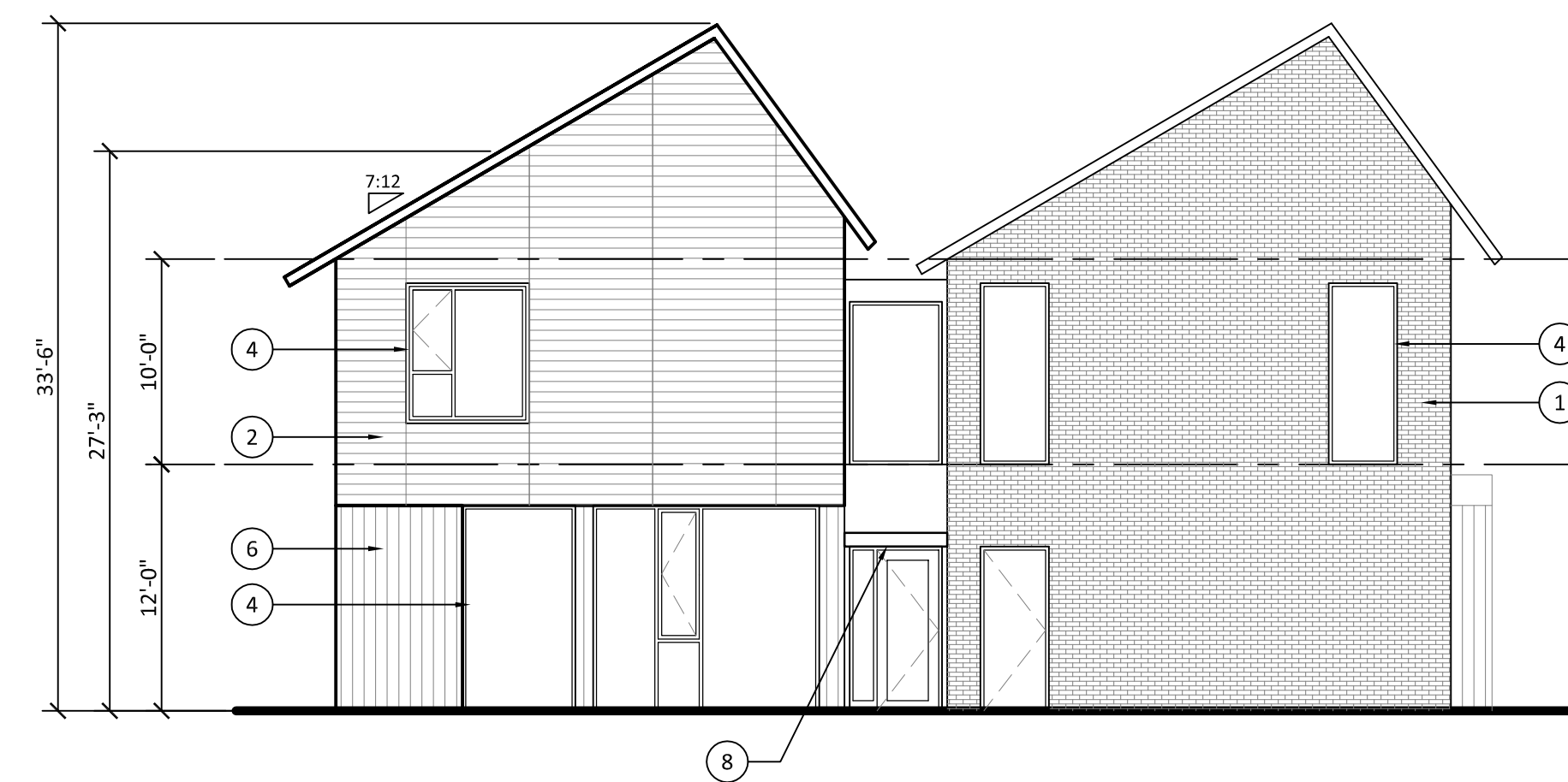
2 EAST ELEVATION SCALE: 1/8" = 1' - 0"
